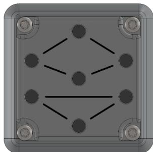
Die Adapterplatte verfügt über 7 Löcher, um je nach Bedarf Verbindungsstücke mit Vakuumsaugern oder Blindschrauben zu verwenden. Anhand von Linien wird gezeigt, welche Löcher miteinander verbunden sind. Dies ist nützlich, wenn die Kanäle unabhängig voneinander für das Generieren von Vakuum verwendet werden.
