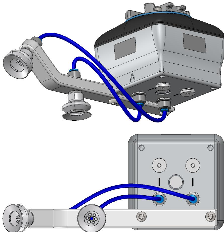
Das untenstehende Bild stellt dar, wie Einschub-Beschläge und normale Beschläge verbunden werden.
