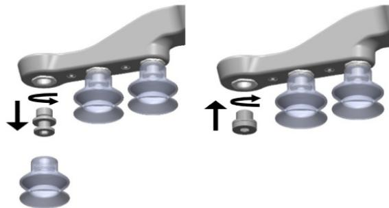
Die Gewindegröße ist das häufig verwendete G1/8", wodurch standardmäßige Verbindungsstücke, Blindschrauben und Verlängerungsschrauben direkt an den VG-Greifern befestigt werden.
