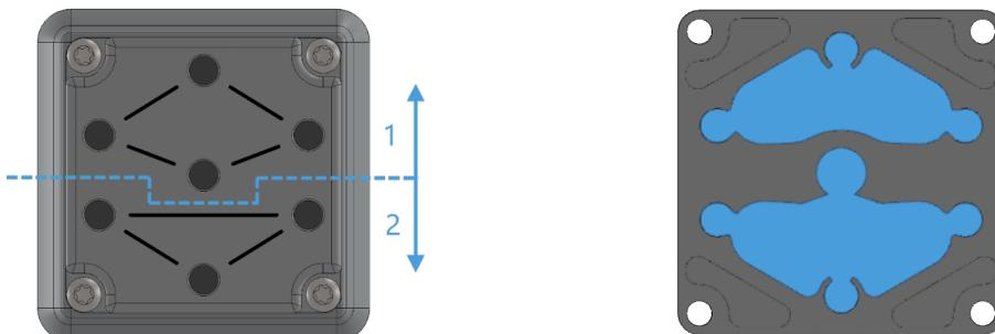
Die Adapterplatte kann durch Drehen um 90° in verschiedene Positionen gebracht werden. Anhand der Buchstaben A und B auf dem Greifergehäuse kann die Adapterplatte so platziert werden, dass die beiden Kanäle getrennt oder miteinander verbunden werden. Wenn die Adapterplatte wie in der Abbildung unten links angebracht wird, werden beide Kanäle getrennt und können unabhängig voneinander oder kombiniert verwendet werden. Wird die
