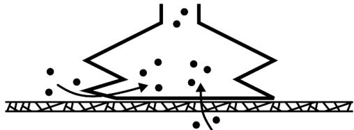
Undichte Werkstücke können noch schwerer zu ermitteln sein. Dinge, die völlig dicht wirken, sind u. U. gar nicht so dicht. Ein typisch Beispiel sind grobe Pappkartons. Die dünne äußere Schicht erfordert oft einen großen Luftstrom, um einen Druckunterschied darüber zu schaffen (siehe Abbildung unten).
